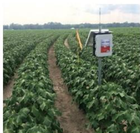
napelemmel működő 24 órás talajnedvességmérő, többszintű szondákkal, mobilhálózaton elérhető adatokkal
