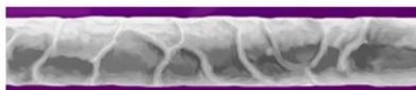
a gyapjuszál plazmakezelés után, a pikkelyek élei legömbölyítettek, nem kapcsolódnak össze a szomszédos szálak
